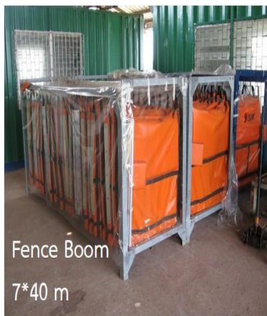
รูปที่ ข.1-13 พุน้ำน้ำมันประเภท Fence Boom ความยาวรวม 280 เมตร
